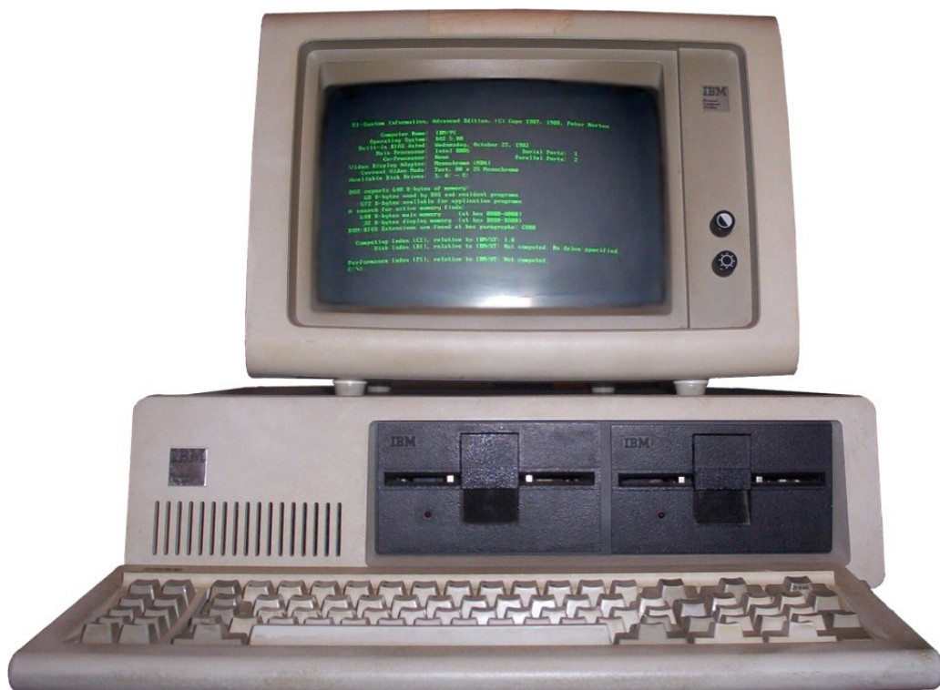
Figura 1.2: Fotografia do IBM PC 5150 (1981), modelo original: gabinete horizontal bege com duas unidades de disquete 5,25", teclado destacado na frente e monitor monocromático verde-sobre-preto apoiado sobre o gabinete, exibindo uma tela de texto de diagnóstico do sistema. Fonte: Wikimedia Commons [7]
